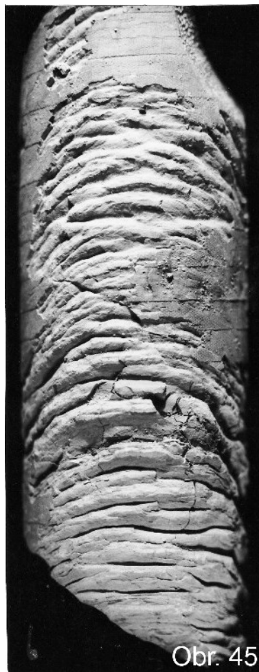
Obr. 45 Vz. S-32 (609,5 m) – svetlosivý až zelenosivý nevápnitý laminovaný ílovec s vysokým obsahom zuhoľnatej rastlinnej hmoty. Vrstvovitost' je mierne uklonená pod uhlom asi 5 – 10°, zvýraznená prítomnosťou drobných šošoviek žltosivého ílu.
