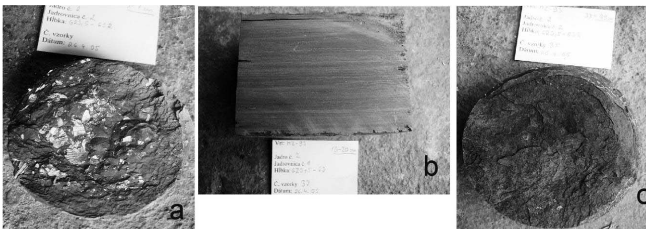
Obr. 41a Vz. M-93 – j. č. 1. (3 – 7 cm) – sivý až červenkastý ílovec so zvyškami ulít lastúrníkov a ulítníkov Obr. 41b Vz. M-93 – j. č. 2 (13 – 20 cm) – sivozelený laminovaný ílovec. Laminy a šošovky majú hrúbku do 4 mm Obr. 41c Vz. M-93 – j. č. 3 (33 – 39 cm) – lignitová vrstva, smerom do nadložía prechádzajúca do uhoľného ílovca
